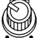
Вращением по часовой стрелке увеличивает уровень высоких частот в обработанном сигнале, против часовой — уменьшает. Обычно обилие высоких частот используется при исполнении сольных партий, т.к. добавляет звуку объём и выразительность.
