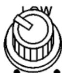
Позволяет регулировать уровень низких частот (басов) в сигнале. Вращением по часовой стрелке уровень увеличивается, против часовой - уменьшается. Обычно обилие басов хорошо при исполнении ритм-партий, так низкие частоты придают звуку необходимую глубину, плотность и энергетику.
