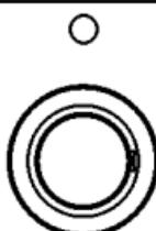
Включение/выключение производится нажатием на кнопку включения эффекта. При включении должен загореться светодиодный индикатор, а при выключении погаснуть. Переключение происходит очень быстро, без посторонних призвуков.
