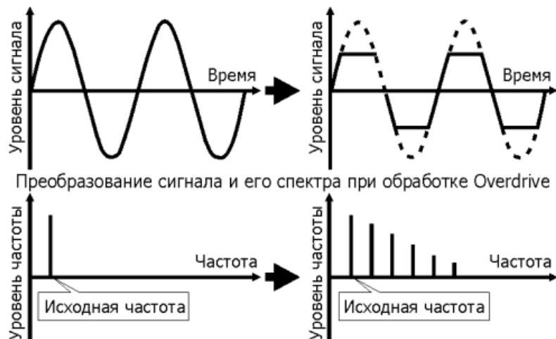
Для получения плотного и выразительного звучания и подавления ненужного высокочастотного треска и шумов ставятся различные фильтры.
