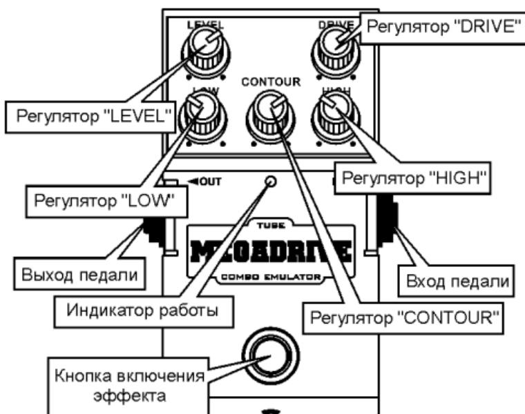
После выполнения описанных выше действий Вы должны услышать из подключённого выходного устройства звук гитары. Когда устройство выключено (индикатор работы не горит), Megadrive работает в режиме "Bypass", то есть никак не искажает и не обрабатывает звук, как бы отсутствуя в цепи "гитара — усилитель". В таком режиме гитарист работает с "чистым" гитарным звуком (баллады, лёгкий аккомпанемент и т.д.).
