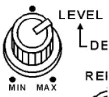
Определяет уровень (громкость) задержанного сигнала, который будет "подмешан" к исходному, то есть выставляет необходимые пропорции между ними. В положении "MAX" сигналы смешиваются в равных долях, а в положении "MIN" присутствует лишь исходный, входной сигнал.
